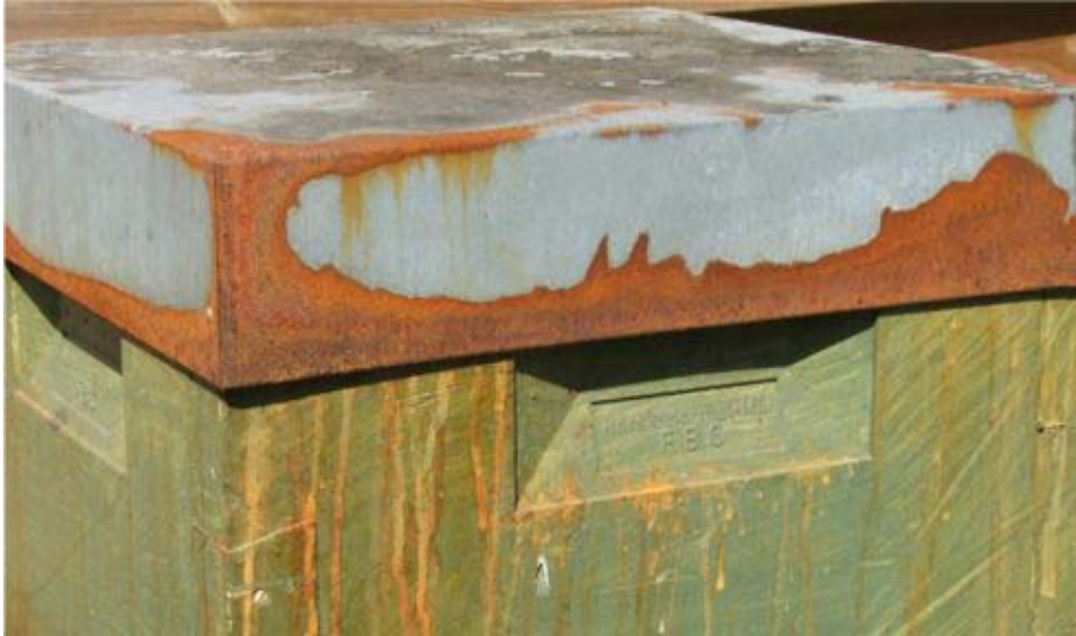
Myresyre er meget ætsende. Den får jern og metal til at ruste. Sådan kan dine bihuslåg let komme til at se ud.
